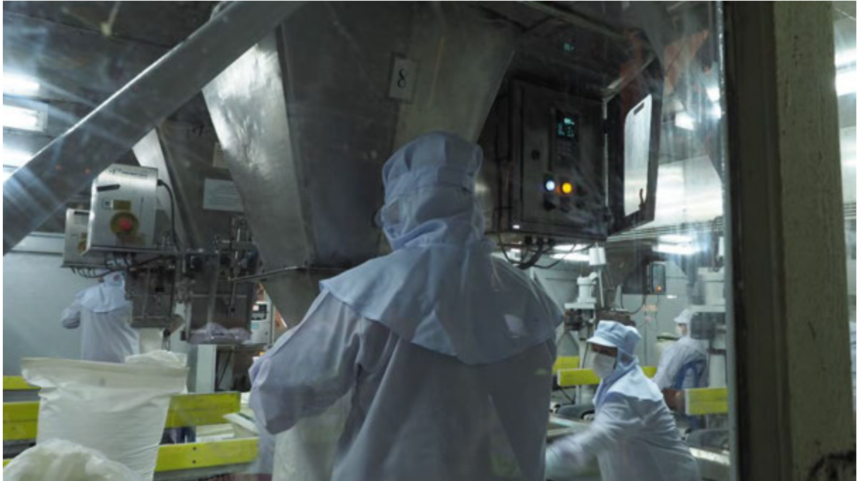
รูปที่ 4.3-9 ขั้นตอนการบรรจุน้ำตาลขนาด 50 กิโลกรัม
