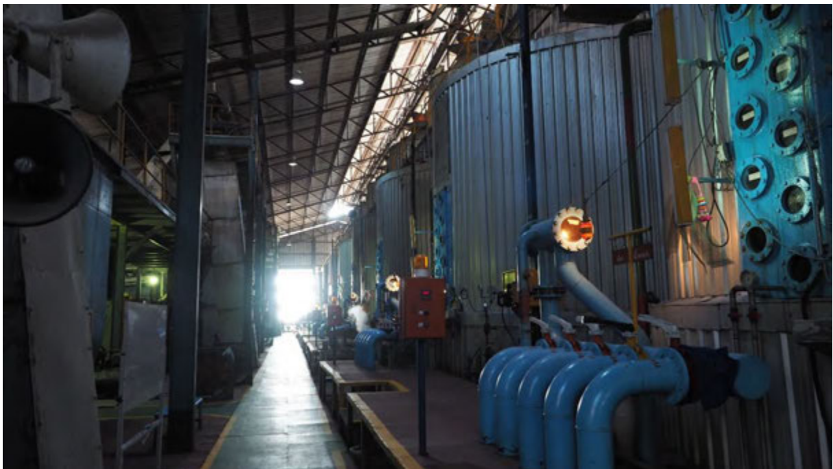
รูปที่ 4.3-6 ขั้นตอนการเคี่ยวน้ำอ้อย
