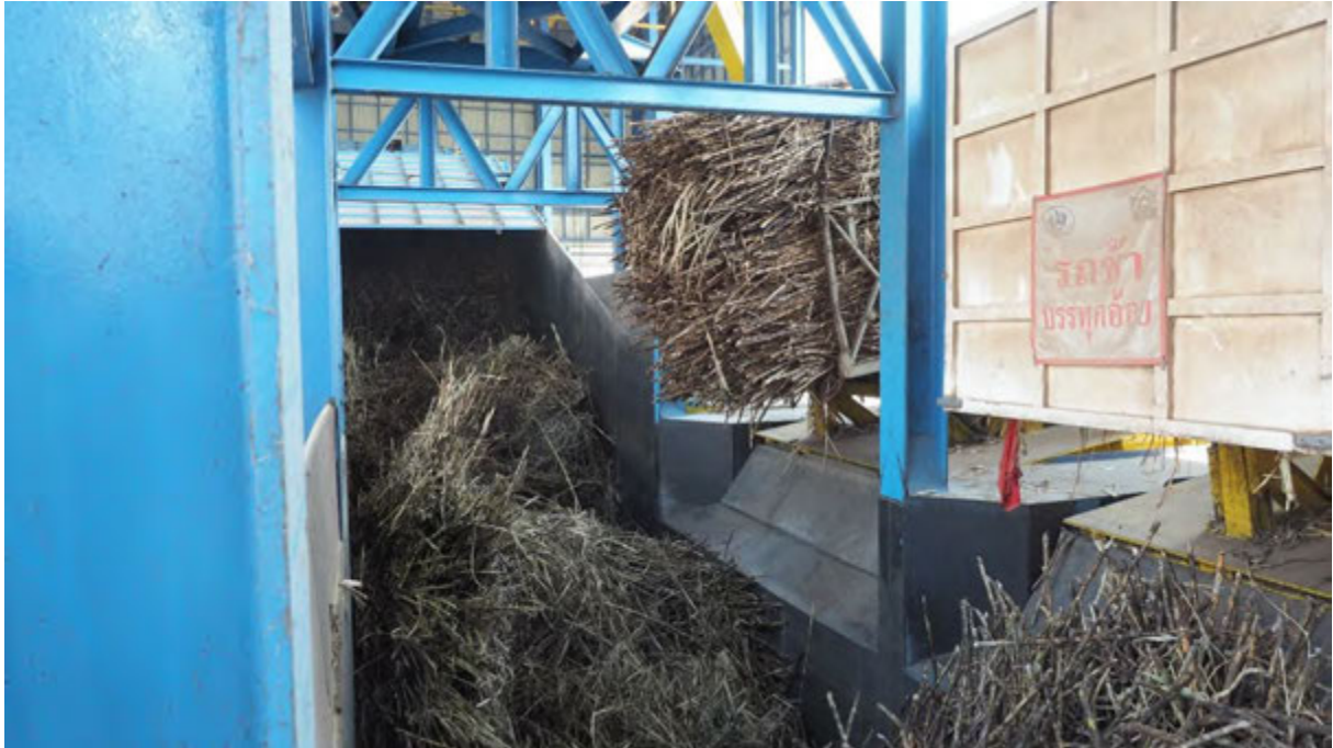
รูปที่ 4.3-3 ขั้นตอนการรับอ้อยเข้าสู่กระบวนการผลิต
