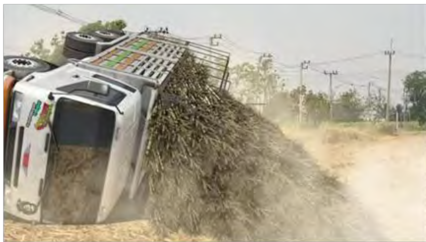
รูปที่ 2.2-6 ลักษณะอุบัติเหตุที่เกิดจากการพลิกคว่ำของรถบรรทุกอ้อยที่บรรทุกสูงเกินไป
