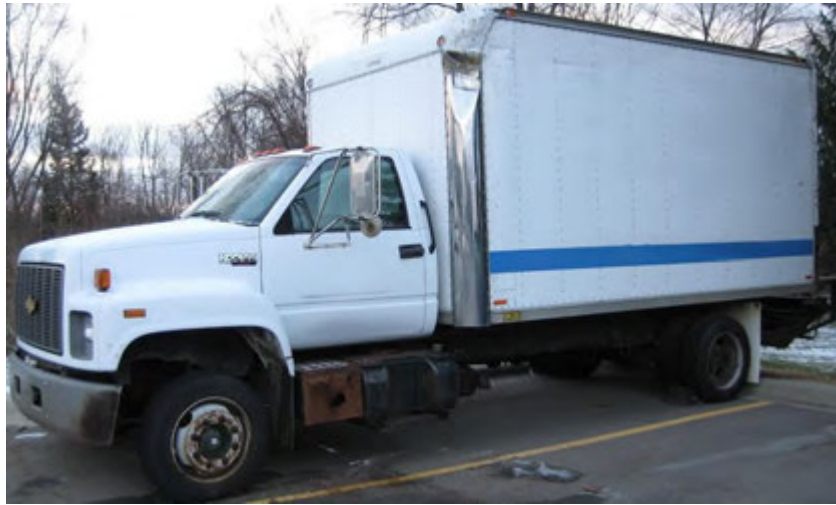
รูปที่ 4.1-2 ตัวอย่างรถบรรทุกขนาดกลาง (Chevrolet Kodiak) ในกลุ่ม class 3 และ 6 [1]
