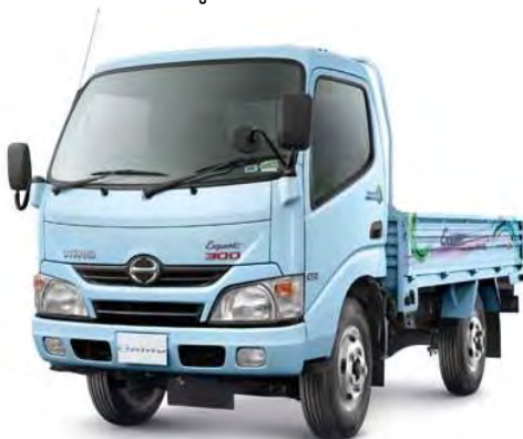
รูปที่ 4.1-5 รถบรรทุกชนิด 2 เพลา 4 ล้อ ยาง 4 เส้น [1]
