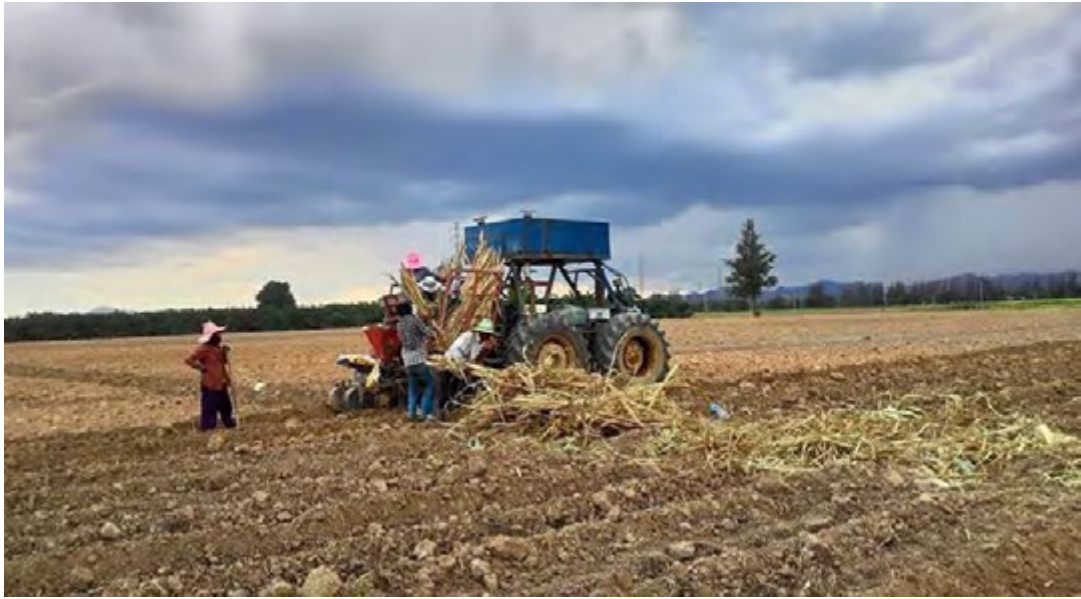
รูปที่ 4.1-17 การลำเลียงอ้อยขึ้นรถบรรทุกด้วยแรงงานคนและรถคืบอ้อย ที่มา: โรงงานพิษณุโลก
