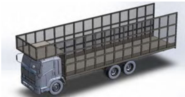
รูปที่ 7.1-7 การปรับปรุงตะกร้ารถบรรทุกสิบล้อแบบตะแกรง
