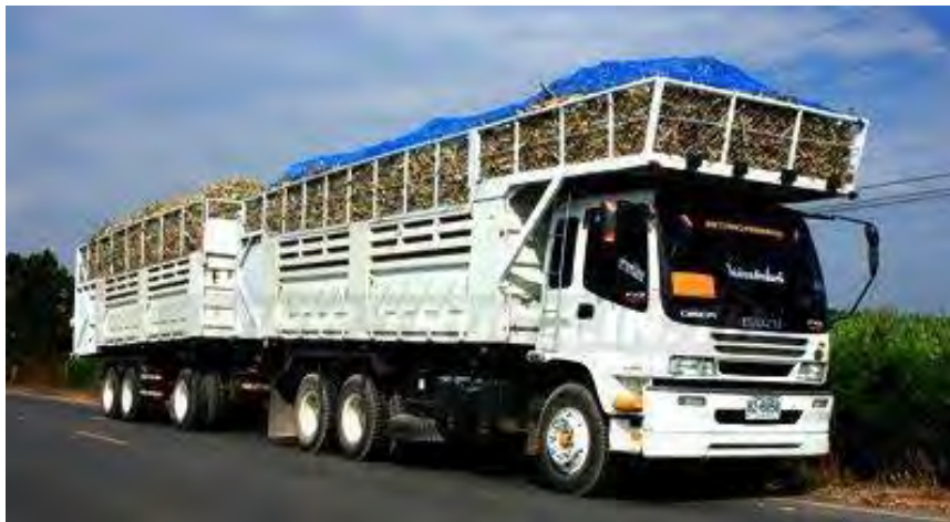
รูปที่ 7.1-6 ลักษณะของรถบรรทุกอ้อยต่อเติมแบบเดิม [23]
