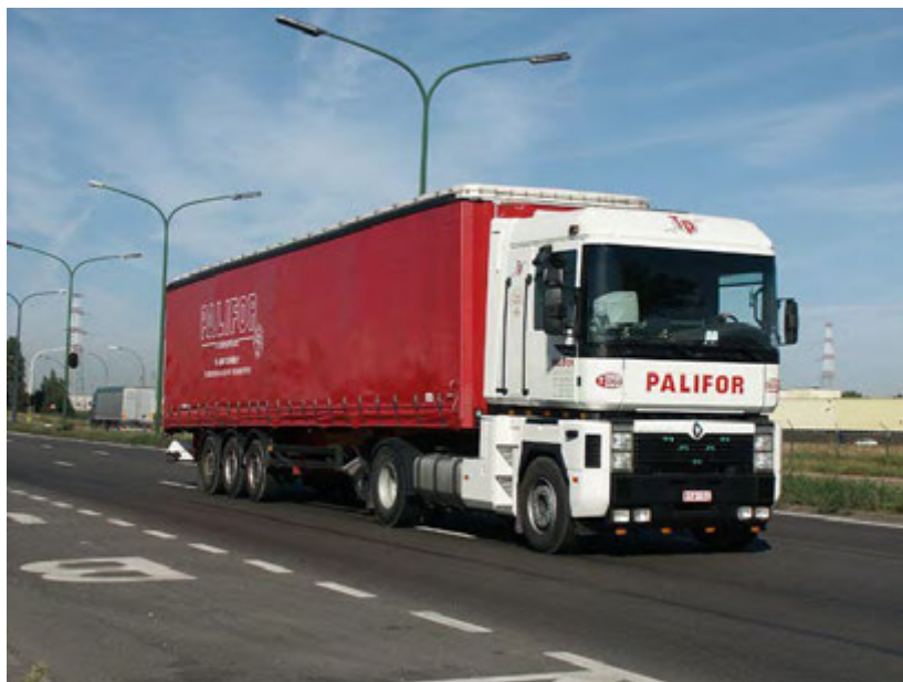
รูปที่ 4.1-3 ตัวอย่างรถบรรทุกหนัก (heavy vehicle) แบบ semi-trailer ที่มีการใช้งานในต่างประเทศ [1]
