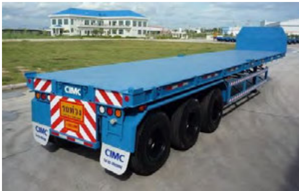
(ค) ลูกฟ่วงสำหรับบรรทุกโครงสร้างขนาดใหญ่
