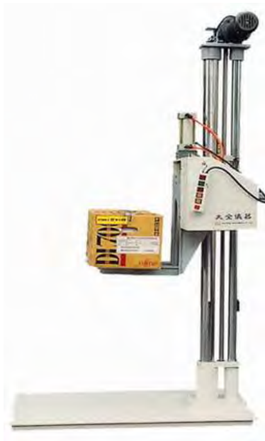
ภาพที่ 2.36 เครื่องทดสอบการต้านแรงตกกระแทก
