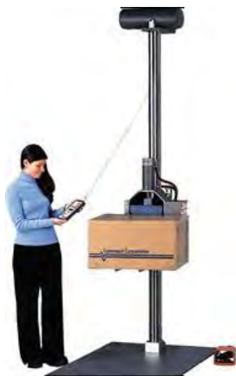
ภาพที่ 3.8 ลักษณะการทดสอบการกระแทกของสินค้า
