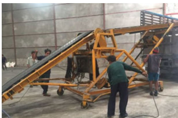
ภาพที่ 2.17 ตัวอย่างสายพานลำเลียงผลิตภัณฑ์น้ำตาล
