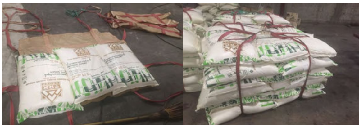
ภาพที่ 2.18 ตัวอย่างลวดสลิง (Pre-sling) เพื่อขนย้ายผลิตภัณฑ์น้ำตาล
