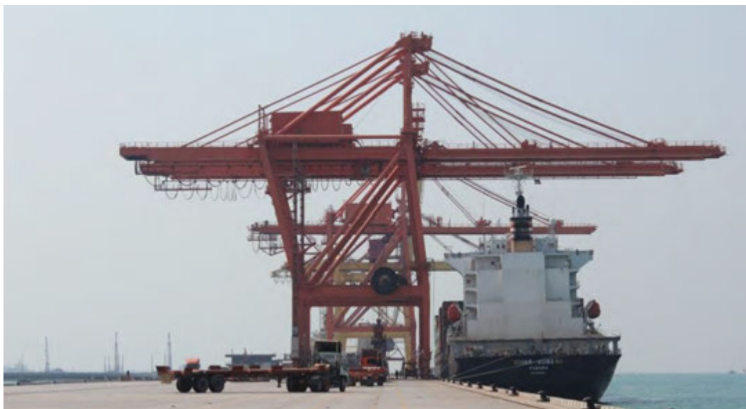
ภาพที่ 2.21 เครนหน้าท่า (Gantry Crane) ขนย้ายสินค้า
