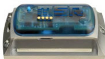
ภาพที่ 3.4 เครื่อง Data Logger for Shock & Vibration Model MSR165
