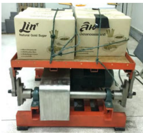
ภาพที่ 3.6 การจำลองสภาพการขนส่งด้วยเครื่อง Simulation Transportation Vibration Table
