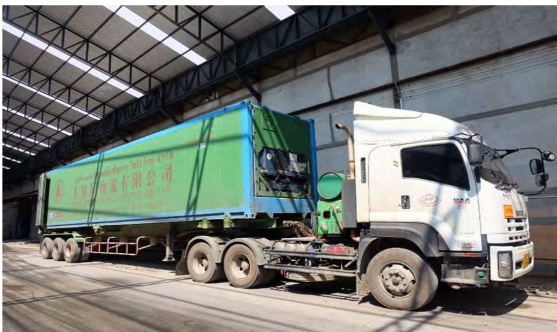
ภาพที่ 4.19 ตู้คอนเทนเนอร์แบบตู้แห้งติดตั้งระบบทำความเย็นขนาดมาตรฐาน 40 ฟุต
