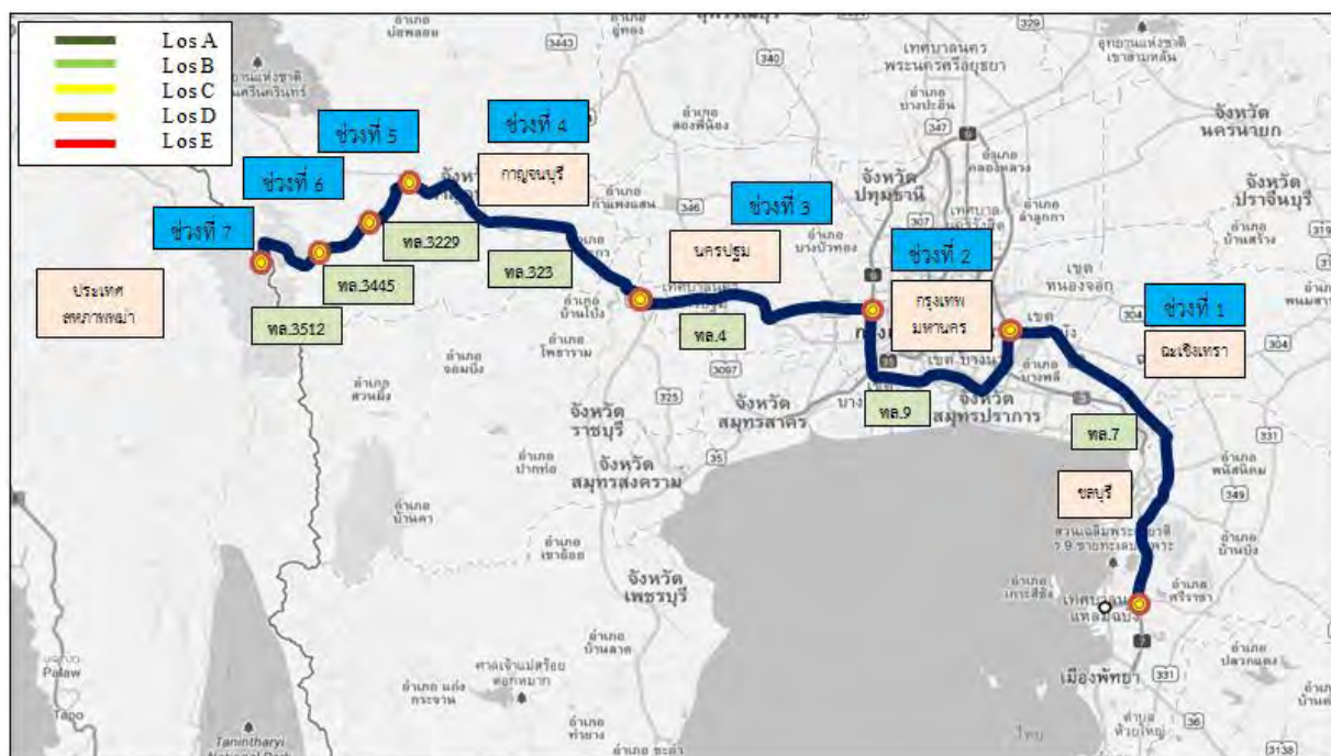
รูปที่ 3.2 โครงข่ายถนนเพื่อรองรับการขนส่งสินค้าระหว่างท่าเรือแหลมฉบังและท่าเรือทวายในปีปัจจุบัน
