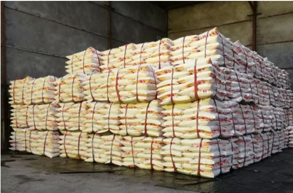
ภาพที่ 30 การจัดเก็บสินค้าแบบ Pre – Sling (ที่มา : คณะวิจัย, 2560)
