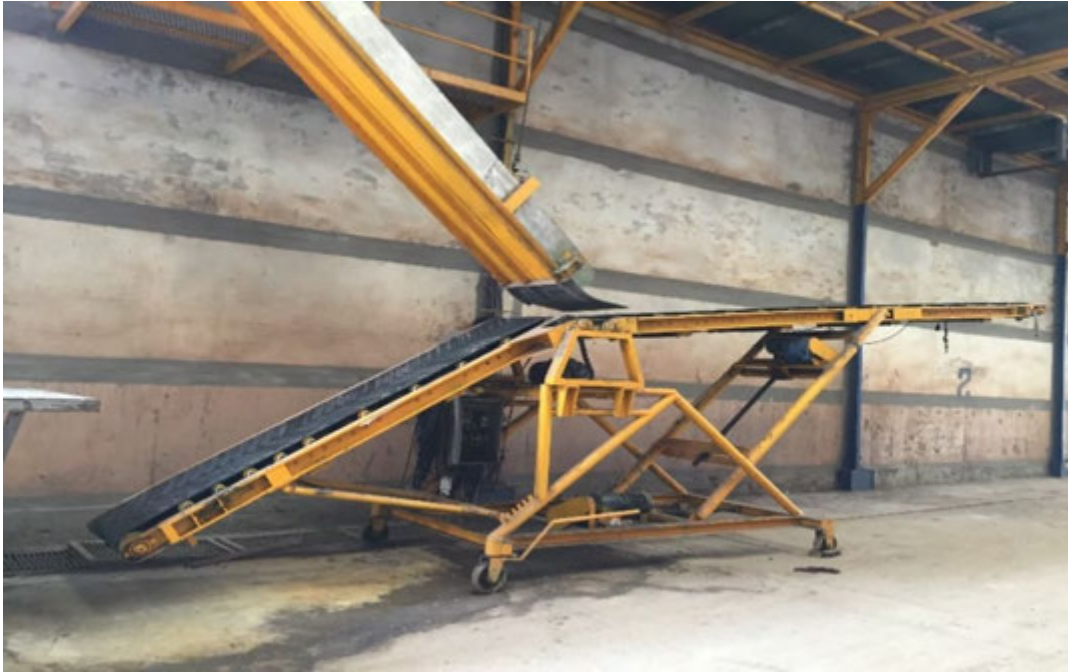
ภาพที่ 26 สานพานเชื่อมต่อ (ที่มา : คณะวิจัย 2560)
